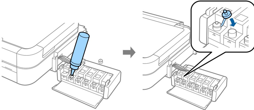
**8** Cierre la cubierta de la unidad de tanques de tinta.
