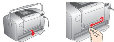
5. Setzen Sie die Patrone in die Patronenhalterung ein und drücken Sie sie dann hinein, bis sie einrastet.
