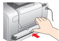
6. Schieben Sie den Hebel nach rechts, dann nach oben und ein wenig nach links. Schließen Sie die Abdeckung.
