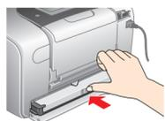
6. Deslice la palanca de bloqueo hacia la derecha, luego hacia abajo y un poco a la izquierda. Cierre la cubierta.
