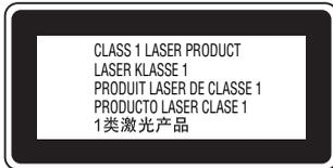
Dieser Drucker ist ein Lasergerät der Klasse 1 entsprechend der Definition in den Spezifikationen IEC60825. Das nachstehende Etikett ist in Ländern mit entsprechenden Gesetzesvorgaben angebracht.
