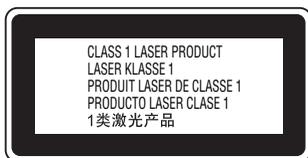
Votre imprimante est un équipement laser de Classe 1 conforme aux spécifications IEC60825. L'étiquette représentée ci-dessous est apposée sur l'imprimante dans les pays où la réglementation l'impose.
