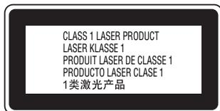
A impressora é um produto laser Classe 1, conforme definido nas especificações IEC60825. A etiqueta apresentada à esquerda está colocada no equipamento, nos países que assim o exigem.
