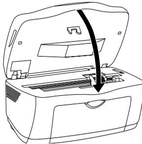
Der Druckkopf bewegt sich und die Aktivierung des Tintenzuleitungssystems beginnt. Während der Aktivierung des Tintenzuleitungssystems blinkt die Kontrollleuchte Ein. Der Aktivierungsvorgang ist beendet, wenn die Kontrollleuchte Ein aufhört zu blinken.
