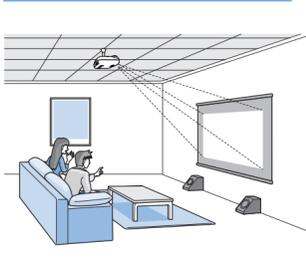
Quando suspender o videoprojector a partir do tecto, altere as definições do menu de configuração.
