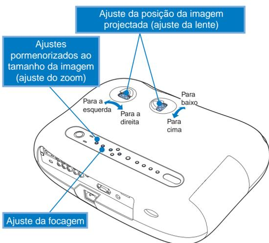
O ajuste do zoom e da focagem devem ser efectuados depois de a lâmpada acender. Se pressionar **Left** ou **Right** o ajuste é efectuado em incrementos de um. Se mantiver o botão pressionado, o ajuste é contínuo.
