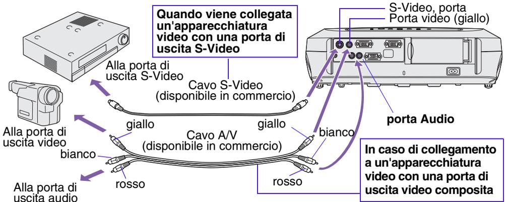
\* Per trasmettere l'audio dall'apparecchiatura video attraverso l'altoparlante incorporato del proiettore, collegare l'attrezzatura video e il proiettore con un cavo A/V (bianco/rosso) oppure un cavo audio RCA.
