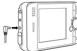
La spia Charge rimane accesa durante la carica. Quando la batteria è completamente carica, la spia Charge si spegne. Sono necessarie circa 3 ore per una carica completa della batteria quando il lettore P-2000 è spento. Il tempo risulta maggiore quando il lettore è in uso.
