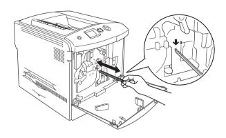
12. Вставьте новый коллектор для отработанного тонера в принтер.
