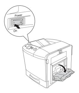
2. Выдвиньте лоток расширения на МЦ-лотке по размеру загружаемой бумаги.
