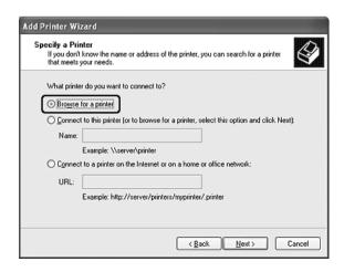
5. Выберите компьютер, который подсоединен к общему принтеру, и имя общего принтера, затем щелкните Next (Далее).
