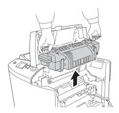
6. Снимите упаковку с нового блока печки и снимите защитную крышку.
