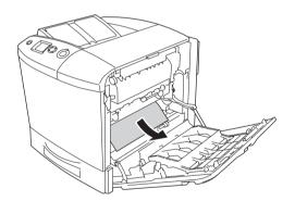
Если дополнительный модуль двухсторонней печати установлен, поднимите его. Удерживая его, осторожно выньте всю бумагу. Будьте осторожны, не оторвите край от замятой бумаги.
