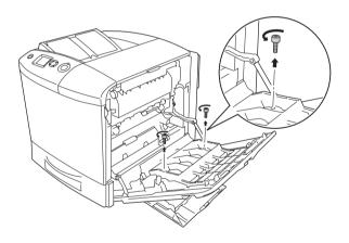
5. Снимите крышку МР с крышки А.
