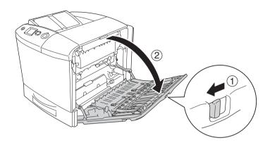
5. Если дополнительный модуль двухсторонней печати не установлен, осторожно выньте всю бумагу. Будьте осторожны, не оторвите край от замятой бумаги.
