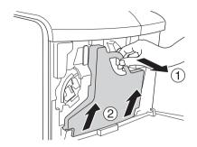
3. Снимите крышку и закройте ею контейнер для отработанного тонера.
