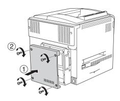
Чтобы убедиться, что дополнительное устройство установлено правильно, напечатайте страницу проверки состояния. См. раздел "Печать страницы проверки состояния" на стр. 387.
