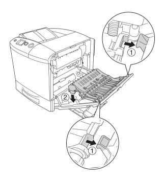
8. Потяните верхнюю часть модуля двусторонней печати вверх и прикрепите модуль к принтеру двумя прилагаемыми винтами.
