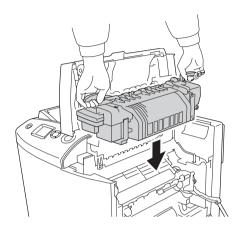
11. Поверните ручки по обеим сторонам печки, чтобы закрыть фиксаторы.
