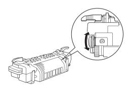
10. Опустите печку в принтер, чтобы направляющие выступы вошли в отверстия в нижней части устройства.
