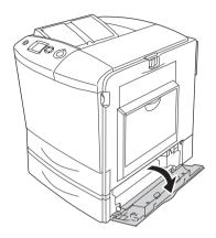
5. Прикрепите дополнительный кассетный лоток к принтеру при помощи прилагаемых пластин и винтов.
