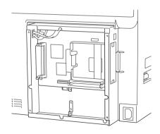
5. Закрепите жесткий диск четырьмя прилагаемыми винтами.
