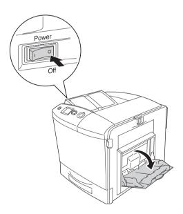
2. Осторожно протрите резиновые части ролика загрузки бумаги в МЦ-лотке хорошо отжатой влажной тканью.
