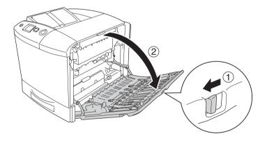
4. Если дополнительный модуль двухсторонней печати не установлен, осторожно выньте всю бумагу. Будьте осторожны, не оторвите край от замятой бумаги.
