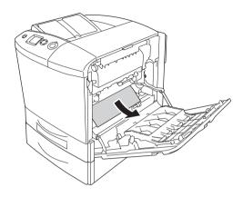
Если дополнительный модуль двухсторонней печати установлен, поднимите его. Удерживая его, осторожно выньте всю бумагу. Будьте осторожны, не оторвите край от замятой бумаги.
