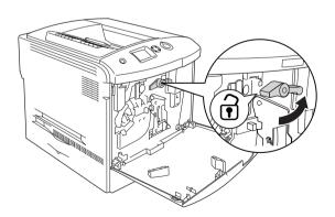
7. Удерживая ручку блока фотокондуктора, потяните ее на себя, чтобы вынуть блок из принтера.
