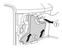
5. Снимите крышку и закройте ей отверстие для контейнера для отработанного тонера.
