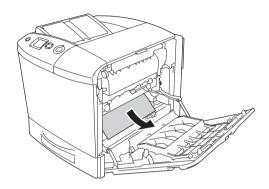
Если дополнительный модуль двухсторонней печати установлен, поднимите его. Удерживая его, осторожно выньте всю бумагу. Будьте осторожны, не оторвите край от замятой бумаги.
