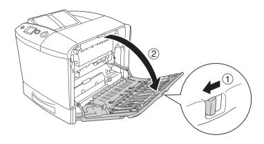
4. Если дополнительный модуль двухсторонней печати не установлен, осторожно выньте всю бумагу. Будьте осторожны, не оторвите край от замятой бумаги.
