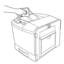
3. Закройте удлинитель на крышке приемного лотка.
