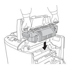
8. Поверните ручки по обеим сторонам печки, чтобы закрыть фиксаторы.
