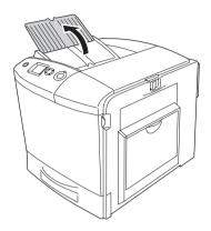
2. Аккуратно протрите путь, по которому проходит выброшенная из принтера бумага, хорошо отжатой влажной тканью.
