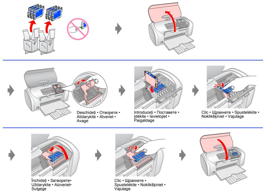
**Notă:** Cartușele de cerneală instalate inițial în imprimantă vor fi utilizate parțial pentru încărcarea capului de imprimare. Următoarele cartușe de cerneală vor funcționa pe întreaga lor durată normată de viață.
