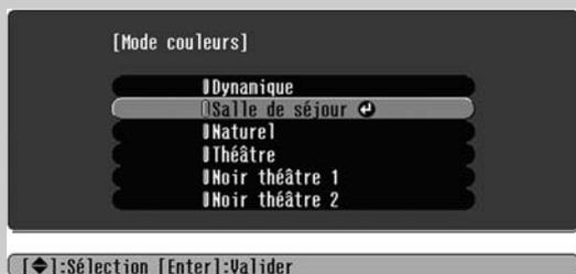
Utilisez les touches et de la télécommande ou les touches et du panneau de commande du projecteur pour sélectionner une option dans le menu.
