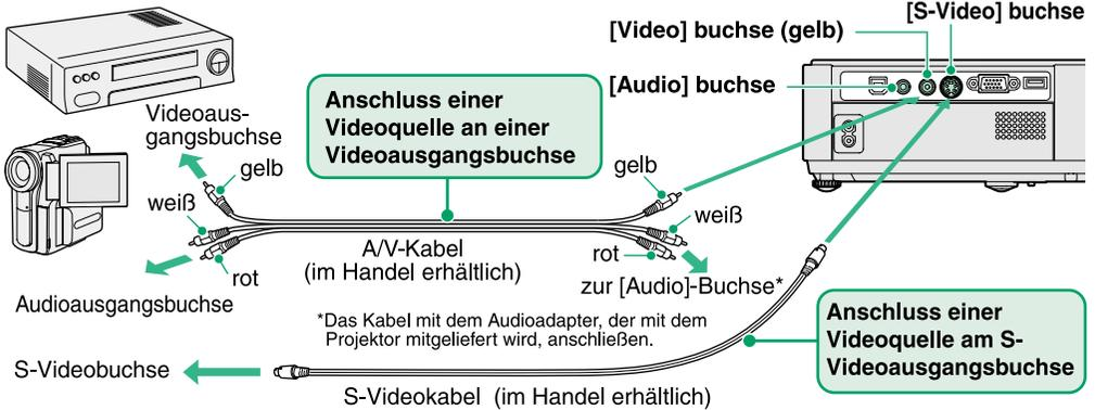
Schließen Sie für eine Tonwiedergabe über den Projektorlautsprecher den Audioadapter (dem Projektor beiliegend) mit einem A/V-Kabel (im Handel erhältlich) an den, der angeschlossenen Videoquelle entsprechenden [Audio]-Buchse an.
