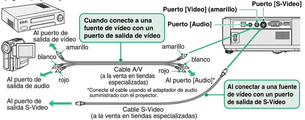
Para reproducir el sonido a través del altavoz incorporado del proyector, use el adaptador de audio (suministrado con el proyector) para conectar un cable A/V (a la venta en tiendas especializadas) al puerto de entrada [Audio] correspondiente a la fuente de vídeo conectada.
