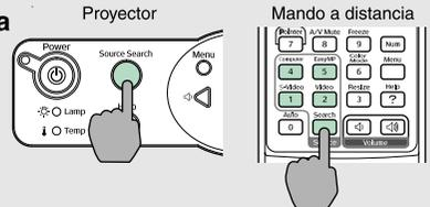
• Si lo conecta a un ordenador con un monitor incorporado, o a un ordenador portátil, deberá cambiar el destino de la salida usando los botones o los menús de ajuste.
