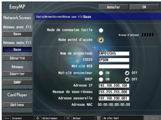
Établissez les réglages permettant au projecteur de fonctionner sur le réseau.
