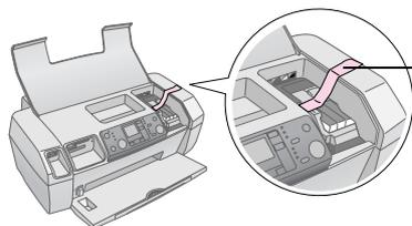
Fissare con del nastro il supporto delle cartucce d'inchiostro al telaio della stampante
