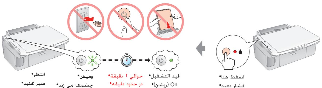
ملاحظة: يتم استخدام خراطيش الحبر التي تم تركيبها أولاً في جهاز EPSON STYLUS CX بشكل جزئي لملء رأس الطباعة. ثم يستمر عمل خراطيش الحبر التالية طوال العمر المقدر لها بالكامل.
