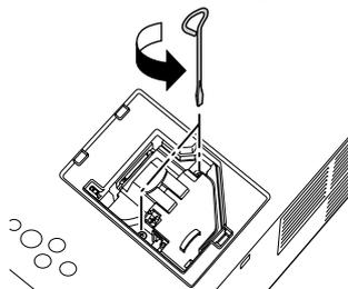
**4** Retire a lâmpada antiga. Ao substituir a lâmpada, tenha cuidado para evitar o contacto com pedaços de vidro partido.
