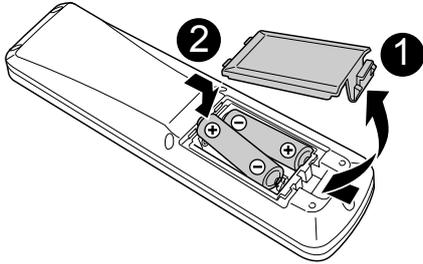
No momento da aquisição, as pilhas não estão instaladas no comando à distância. Antes de utilizar, insira as pilhas que são fornecidas com esta unidade.
