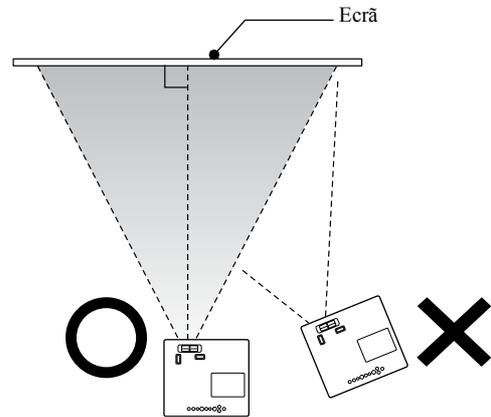
Se esta unidade não for colocada paralelamente ao ecrã, a imagem projectada fica distorcida, com um formato trapezoidal (distorção keystone).
