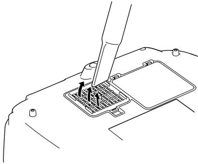
في حالة انسداد مرشح الهواء بالأتربة وظهور رسالة "The projector is overheating. Make sure nothing is blocking the air vent, and clean or replace the air filter" (تزداد درجة حرارة آلة العرض بصورة بالغة. تأكد من عدم وجود انسداد بفتحة الهواء، نظف أو استبدل مرشح الهواء)، قم بتنظيف مرشح الهواء. اقلب آلة العرض رأساً على عقب واستخدم المكنسة الكهربائية لتنظيف مرشح الهواء.
