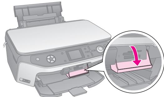
3. مطمئن شويد چراغ کارت حافظه (که در کنار شکافهاي کارت قرار دارد) خاموش بوده و همه شکافها خالي باشند. سپس کارت حافظه را در جاي خود قرار دهيد (← صفحه ۱۵).
