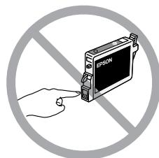
گر کارتیج جوهر را برای استفاده در یک فرصت دیگر خارج می کنید. از مخزن جوهر در برابر گرد و غبار محافظت نمایید و آنرا در محیطی مشابه EPSON STYLUS PHOTO RX قرار دهید. پورت مخزن جوهر دارای یک دریچه است که با وجود آن نیازی به پوشش ویا درپوش نیست. ولی باید مراقب بود افلامی که در معرض کارتیج قرار می گیرند به جوهر آغشته نشوند به پورت مخزن جوهر یا قسمتهای اطراف آن دست نزیند.
