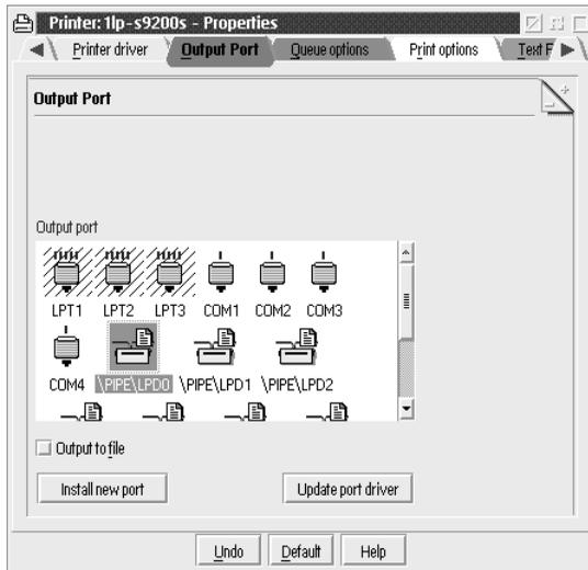
5. Wählen Sie im Listenfeld Output Port (Ausgangsanschluss) einen Anschluss zwischen `\PIPE\LPD0` und `\PIPE\LPDn` aus (n ist die maximale Anzahl der LPD-Anschlüsse). Das Dialogfeld `\PIPE\LPD`-Einstellungen wird angezeigt.
