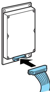
3. Branchez l'autre extrémité du câble au connecteur de disque dur de la carte à circuits imprimés.
