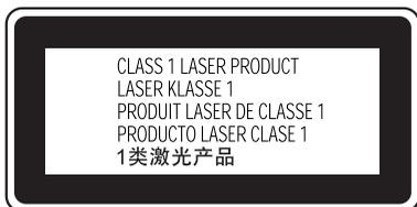
Votre imprimante est un équipement laser de Classe 1 conforme aux spécifications IEC60825. L'étiquette représentée ci-dessous est apposée sur l'imprimante dans les pays où la réglementation l'impose.
