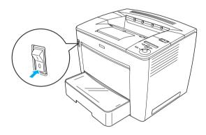
2. Ligue o cabo de alimentação na parte posterior da impressora. Depois ligue a outra extremidade do cabo a uma tomada.
