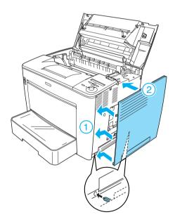
2. Fixe a tampa com os parafusos, conforme apresentado em seguida.
