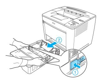
4. Retire os adesivos que prendem a tampa do alimentador e remova a tampa. Em seguida, retire todos os adesivos e materiais de protecção do interior do alimentador.
