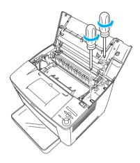
4. Retire os dois parafusos localizados junto à parte inferior do lado direito da impressora.
