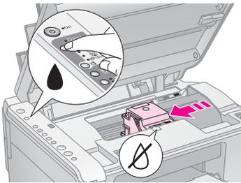
Si aucune des cartouches n'est vide ou si leur niveau d'encre n'est pas faible, la tête d'impression se met en position de remplacement de cartouche. Passez à l'étape 5.
