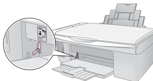
La lettre L apparaît brièvement dans la fenêtre
