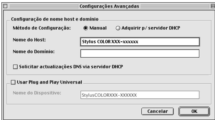
9. Selecciona Manual ou Adquirir p/ servidor DHCP (Acquire Using DHCP Server). Apenas pode seleccionar Adquirir p/ servidor DHCP (Acquire Using DHCP Server) se tiver seleccionado o método Automático (Automatic) em Obter Endereço de IP (Get IP Address), no ponto 4.
