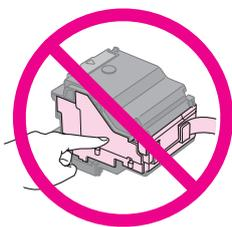
4. Retire o tinteiro que tem de substituir. Aperte a patilha situada na parte posterior do tinteiro e retire o tinteiro. Deite-o fora tomando as devidas precauções.
