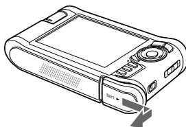
2. Inserire la batteria nello scomparto in base alla direzione della freccia sull'adesivo della batteria.
