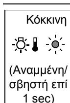
Εσωτερικό πρόβλημα / Πρόβλημα ανεμιστήρα / Πρόβλημα αισθητήρα / Πρόβλημα κινηματογραφικού φίλτρου / πρόβλημα στο αυτόματο διάφραγμα
