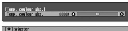
Utilisez les touches ◀ et ▶ de la télécommande ou les touches ◀ et ▶ du panneau de commande du projecteur pour sélectionner une option dans le menu.
