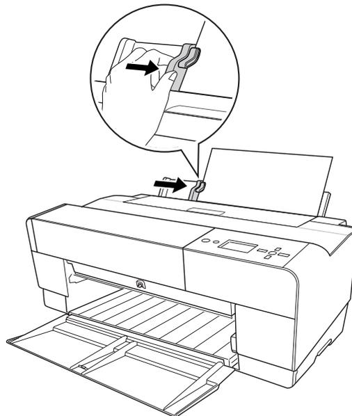
6. Führen Sie das Papier bis zum Anschlag in den Schacht ein. Drücken Sie das Papier mit konstantem Druck (ca. drei Sekunden), bis der Drucker das Papier ein Stück einzieht.
