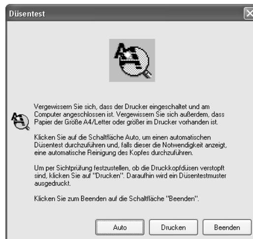
4. Führen Sie die angezeigten Anweisungen aus, um ein Düsentestmuster zu drucken.
