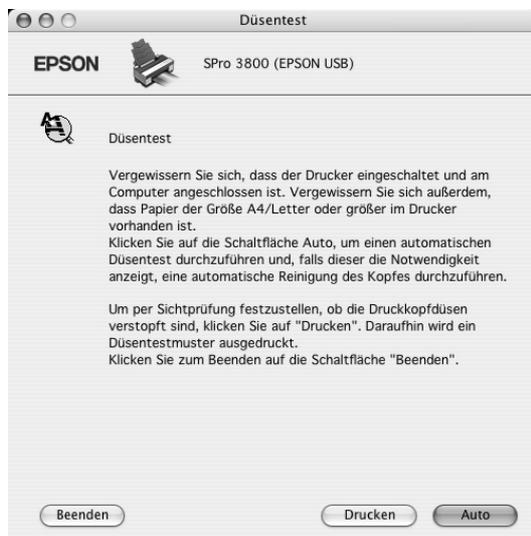
4. Führen Sie die angezeigten Anweisungen aus, um ein Düsentestmuster zu drucken.
