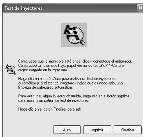
4. Siga las instrucciones de la pantalla para ejecutar un patrón de test de inyectores.
