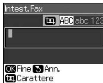
5. Per specificare i dati dell'intestazione, usare il tastierino numerico e i pulsanti del pannello di controllo (→ "Utilizzo del pulsanti del pannello di controllo in modalità Fax" a pagina 11). È possibile immettere fino a un massimo di 40 cifre.
