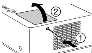
**3** Desaperte os parafusos de fixação da lâmpada.
