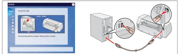
Conectați la calculatorul dumneavoastră.
