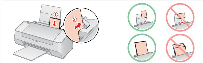
Încărcați hârtia cu partea imprimabilă orientată în sus.
