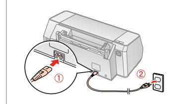
Conectați echipamentul și introduceți-l în priză.
