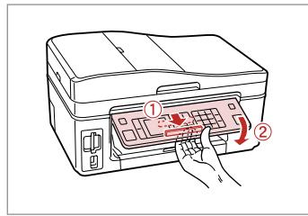
Če želite spustiti ali zapreti ploščo, jo odklenite tako da premaknete ročico na zadnji strani dokler ne slišite klik in jo spustite. Ploščo enostavno dvignite.
