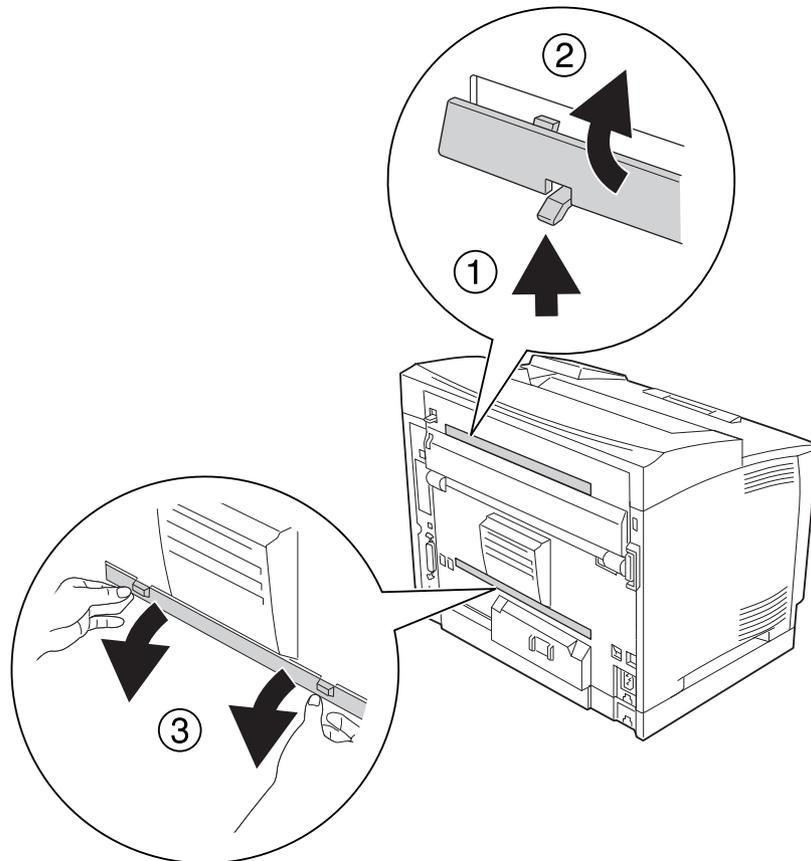
3. Entfernen Sie die Anschlussabdeckung für die Duplexeinheit.
