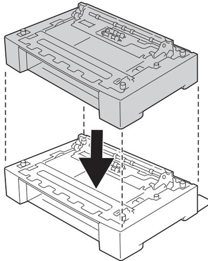
7. Sichern Sie die optionalen Papiermagazine mit den vier Verbindungsstücken. Installieren Sie zwei der vier Verbindungsstücke jeweils innen an beiden Seiten des optionalen Papiermagazins und die anderen beiden jeweils außen auf beiden Seiten.
