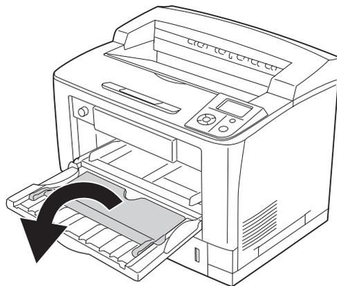
3. Legen Sie einen Stapel des gewünschten Papiers mit der bedruckbaren Seite nach oben ein. Verschieben Sie dann die Papierführungen so, dass sie eng am Papier anliegen.
