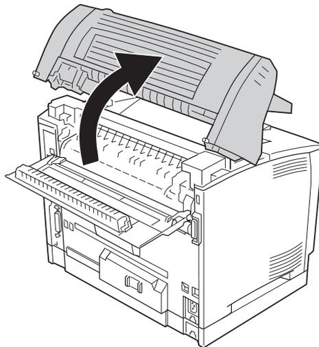
5. Setzen Sie die rechte und linke Lasche der oberen Abdeckung in die Öffnungen oben am Drucker ein.
