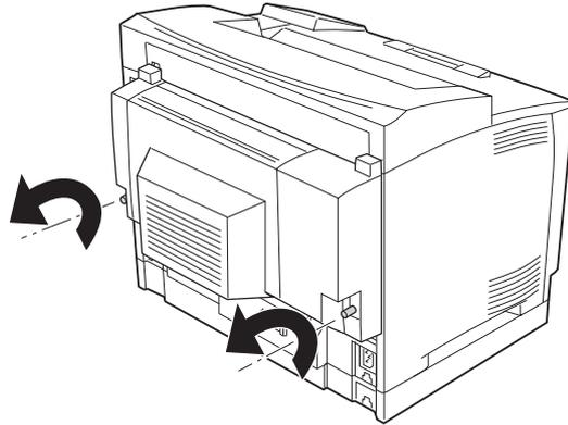
3. Drücken Sie den Entriegelungsknopf, um die Haken zu entriegeln, und nehmen Sie die Duplexeinheit vom Drucker ab.
