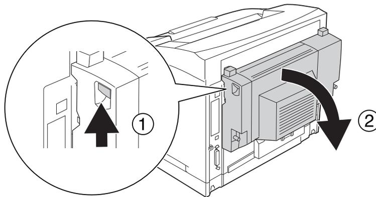
4. Bringen Sie die beim Einbau der Duplexeinheit abgenommene Anschlussabdeckung der Duplexeinheit wieder an.
