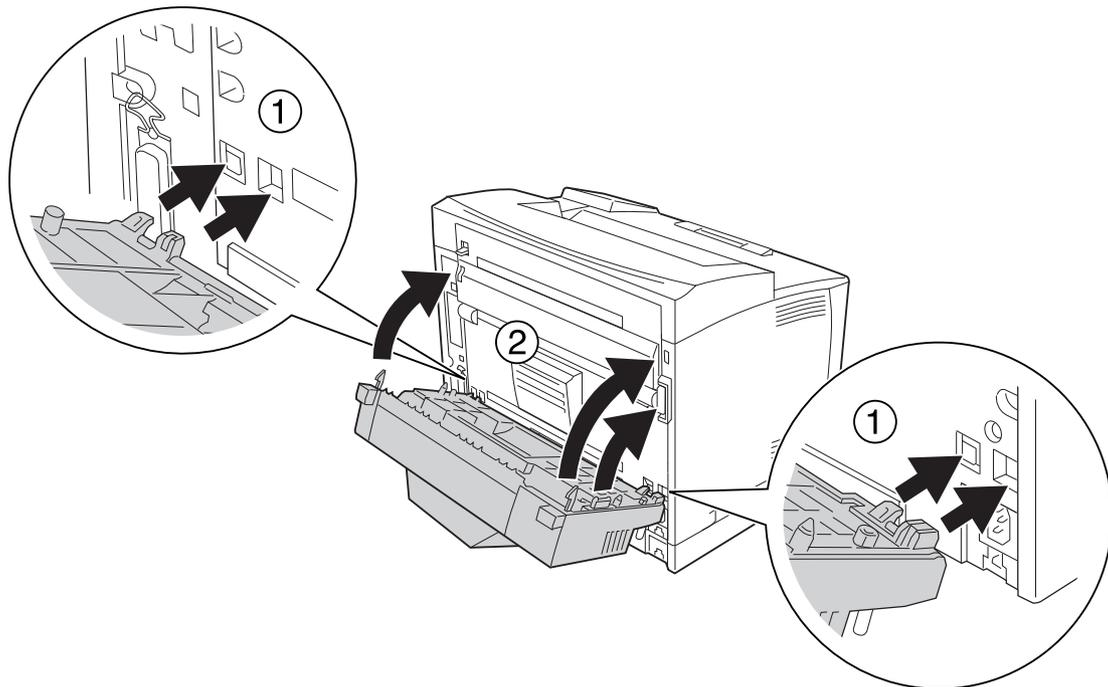
5. Sichern Sie die Duplexeinheit mit zwei Schrauben.
