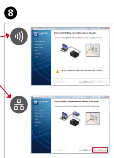
W przypadku połączenia bezprzewodowego WiFi (także dla typu Ad Hoc) podłącz **Przewod USB**.
