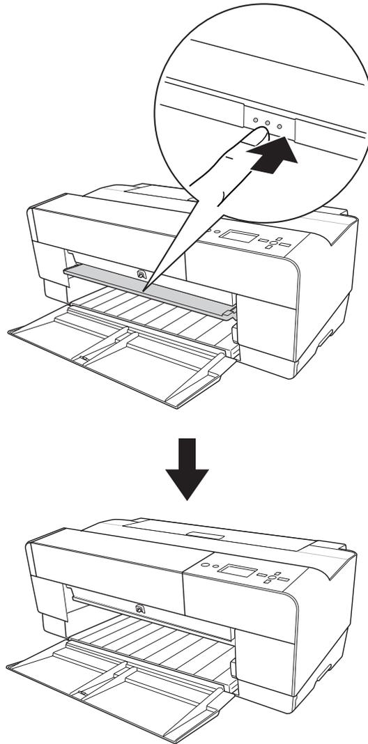
3. Aprire il coperchio superiore e quindi utilizzare un panno morbido e pulito per rimuovere delicatamente ogni traccia di polvere o sporco dall'interno della stampante. Se il retro di una stampa risulta sporco, pulire attentamente il supporto (la parte magenta chiaro) utilizzando un panno morbido e pulito nelle direzioni indicate dalle frecce.
