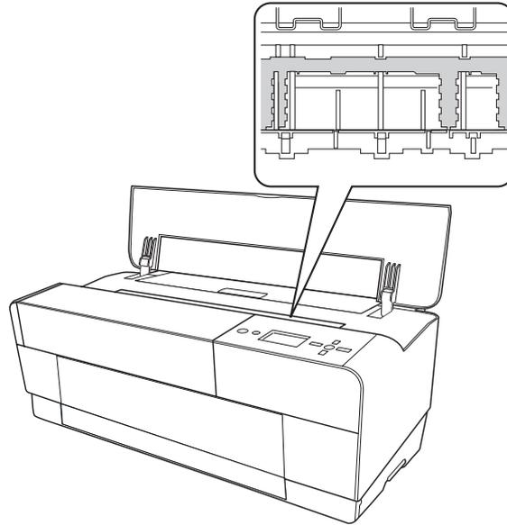
2. Se il vassoio manuale anteriore viene aperto, chiuderlo premendolo verso l'interno.
