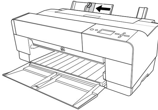
4. Usando la guida per fogli posteriore, inserire la carta nella feritoia di alimentazione manuale posteriore allineandola alla guida laterale destra.
