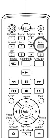
L'unità riconosce automaticamente l'aspetto adatto al segnale in ingresso per una proiezione corretta dell'immagine. Se si desidera cambiare l'aspetto oppure se l'aspetto non è corretto, eseguire le operazioni seguenti.
