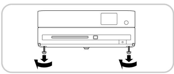
Se si allungano i piedini e si solleva l'unità da un lato, l'immagine risulterà distorta, assumendo una forma trapezoidale. Per correggere la distorsione, attenersi alla seguente procedura.
