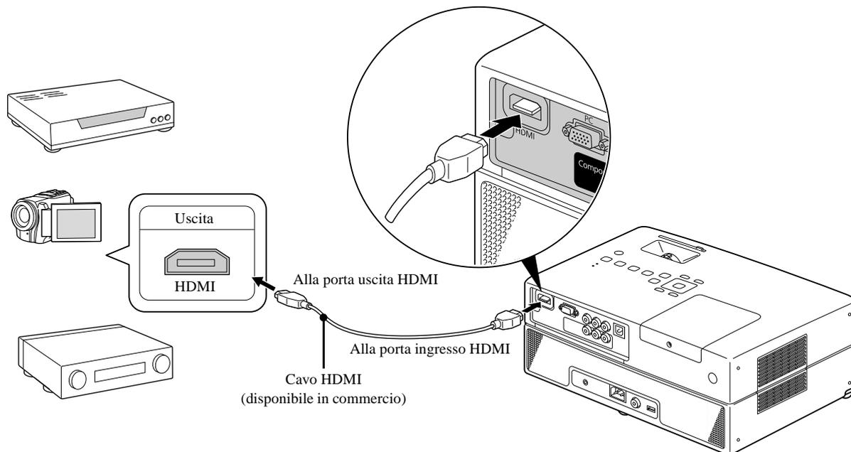
Utilizzare un cavo HDMI conforme allo standard HDMI; diversamente, l'immagine potrebbe non essere nitida o non apparire del tutto.
