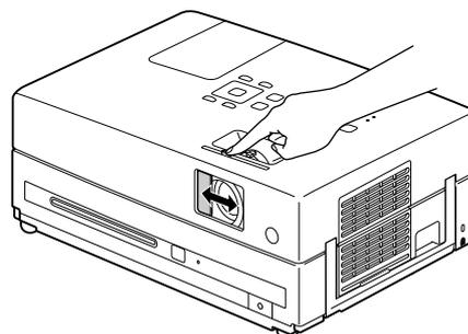
Ogni volta che si preme questo tasto o si apre e si chiude il coprilenti, viene attivata o disattivata l'opzione A/V Mute.
