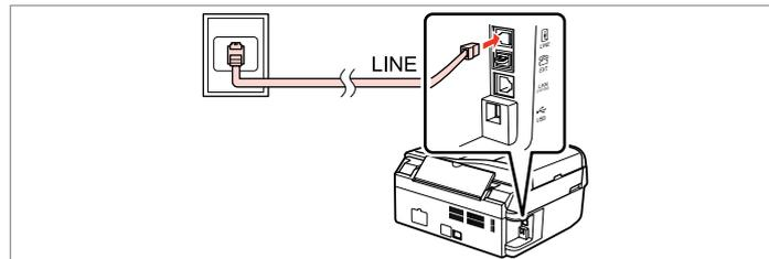
Povežite telefonski kabel iz zidne telefonske vtičnice z vrati **LINE**.
