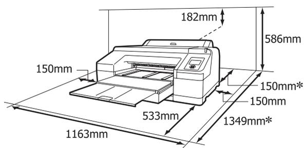
\* L'espace suivant est nécessaire à l'arrière de l'imprimante lorsque vous imprimez sur du papier épais ou depuis un bac papier équipé du SpectroProofer en option.
