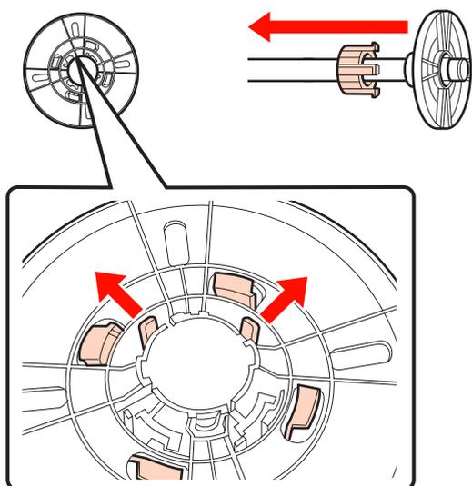
**Installation de la fixation (si un mandrin 3" est utilisé)**
