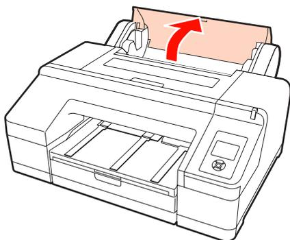
**4** Maintenez avec l'embout gris (fixe) sur la droite, placez les deux côtés de l'axe dans le support de l'axe sur l'imprimante.
