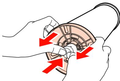
Si l'embout ne ressort pas facilement, tapez légèrement sur l'extrémité de l'axe sur le côté de l'embout noir.
