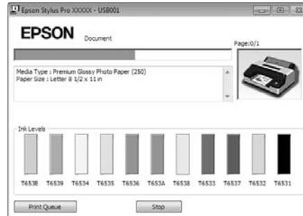
Un message d'erreur s'affiche en cas d'erreur ou si une cartouche d'encre doit être remplacée avant l'impression.
