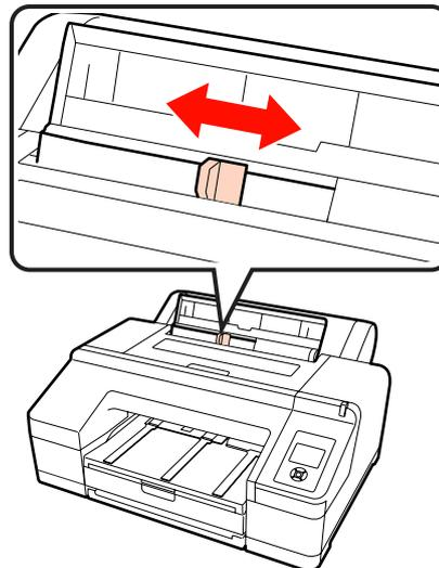
**5** Insérez le papier dans le chargeur manuel arrière, face imprimable orientée vers le haut comme indiqué sur l'illustration.
