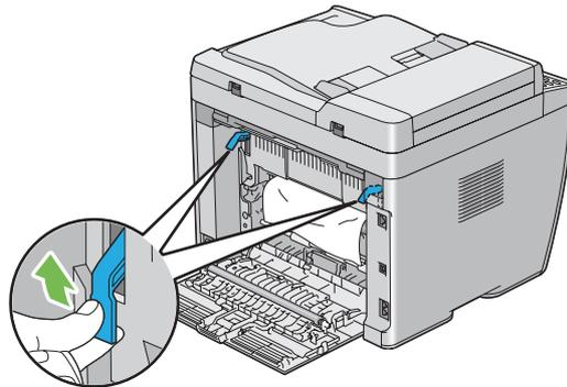
3. Entfernen Sie jegliches gestautes Papier von der Rückseite des Druckers. Wenn kein Papier im Papierpfade gefunden wird, prüfen Sie das mittlere Ausgabefach von der Vorderseite des Druckers her.
