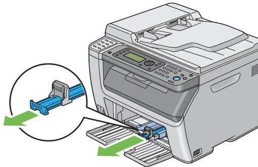
4. Ziehen Sie die Längsführung bis zum Anschlag nach vorne.
