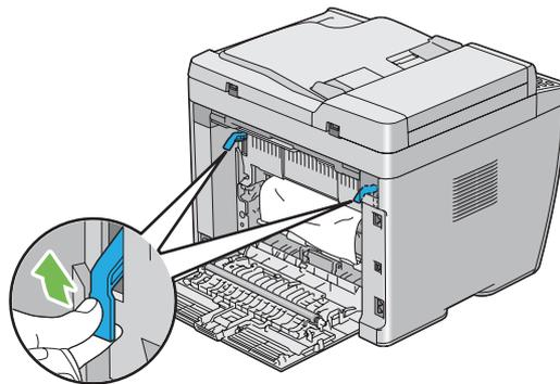
3. Entfernen Sie jegliches gestautes Papier von der Rückseite des Druckers.
