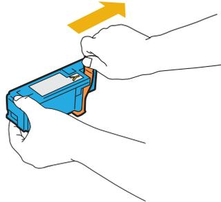
3. Justieren Sie die Tonerkassette, indem Sie sie an den zugehörigen Kassettenhalter setzen, und setzen Sie sie dann fest ein, indem Sie in der Nähe des Etiketts drücken, bis die Tonerkassette mit Klickgeräusch einrastet.
