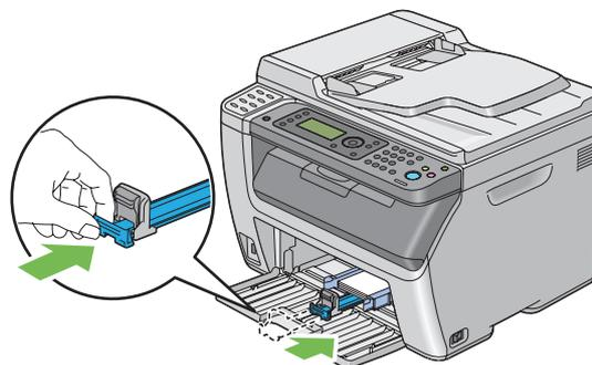
10. Schieben Sie den PSI in den Drucker und richten dann den PSI auf die Markierung am MPF aus.
