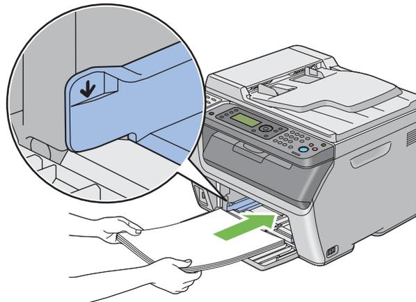
8. Stellen Sie die Papierbreitenführungen ein, bis sie leicht gegen die Kanten des Stapels des Druckmediums andrücken.
