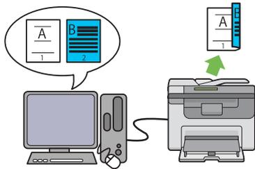
Duplexdruck bedeutet, zwei oder mehr Seiten auf den Vorder- und Rückseiten eines einzelnen Blatts Papier manuell zu drucken. Dieses Merkmal erlaubt es Ihnen, den Papierverbrauch zu verringern.
