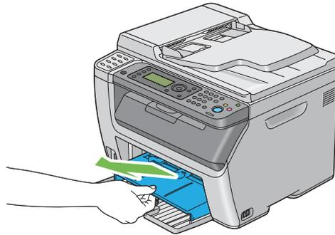
2. Entfernen Sie jegliches gestautes Papier von der Vorderseite des Druckers.
