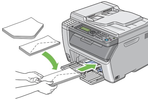
Um Zerknittern von DL und Monarch zu verhindern, wird empfohlen, sie mit der zu bedruckenden Seite nach oben, geöffneter Klappe und zu Ihnen hinweisend einzulegen.
