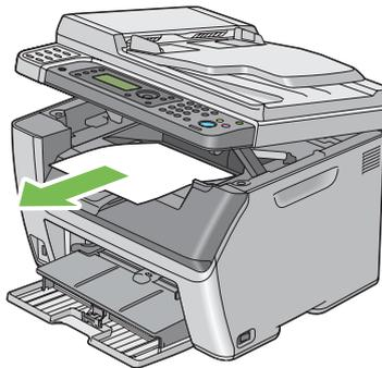
5. Entfernen Sie jegliches Papier im Prioritäts-Deckblatteinzug (PSI) oder Mehrzweckeingang (MPF). Halten Sie das Papier verpackt und vor Luftfeuchtigkeit und Schmutz geschützt.
