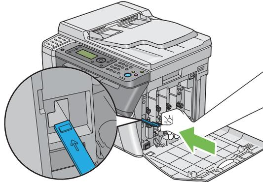
10. Ersetzen Sie die schwarze Tonerkassette, indem Sie sie an den zugehörigen Kassettenhalter setzen, und setzen Sie sie dann fest ein, indem Sie in der Nähe des Etiketts drücken, bis die Tonerkassette mit Klickgeräusch einrastet.
