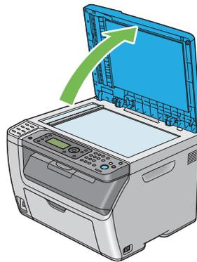
2. Legen Sie das Dokument mit der Vorderseite nach unten auf die Dokumentenauflage und richten Sie das Dokument mit der Registrierführung oben links an der Dokumentenauflage aus.
