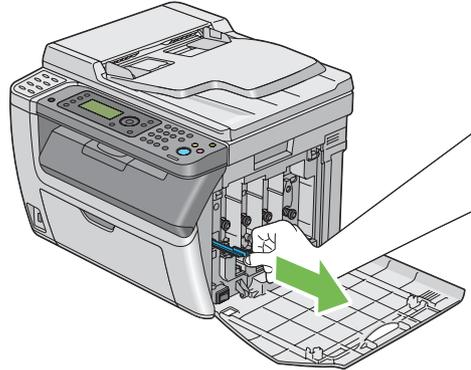
7. Setzen Sie den Druckkopf-Reinigungsstab vollständig in das Loch neben dem Pfeil am Drucker ein, bis dessen Spitze das Innere des Druckers erreicht, wie in der Abbildung unten gezeigt, und ziehen ihn dann heraus.
