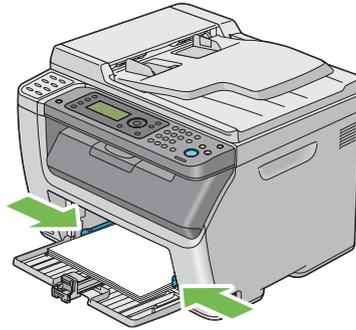
9. Schieben Sie die Längsführung zum Drucker, bis sie das Druckmedium berührt.
