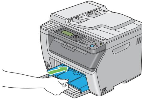
7. Schieben Sie den Schieber bis zum Anschlag nach hinten.
