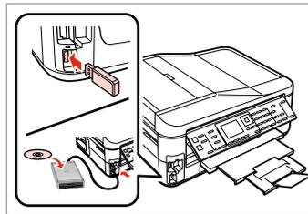
Priključite zvanjnu napravo USB.
