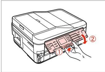
Če želite spustiti ali zapreti ploščo, povlecite ročico na zadnji strani nadzorne plošče in jo nato spustite. Ploščo enostavno dvignite.
