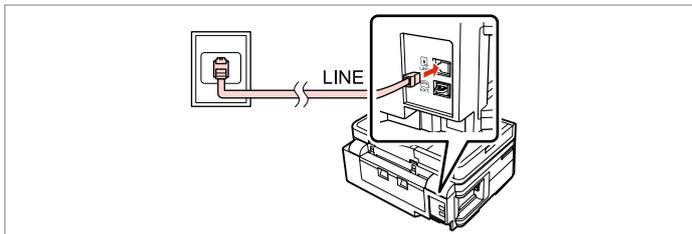
Povežite telefonski kabl iz zidne telefonske vtičnice z vrati **LINE**.
