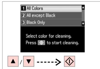
Izberite element in začnite čišćenje.
