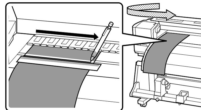
**[7]** Potiahnite nastavovací papier zo zadnej strany, potiahnite ho do ľavého konca rolky, vložte ho do tlačiarne a zasuňte ho celý dovnútra.
