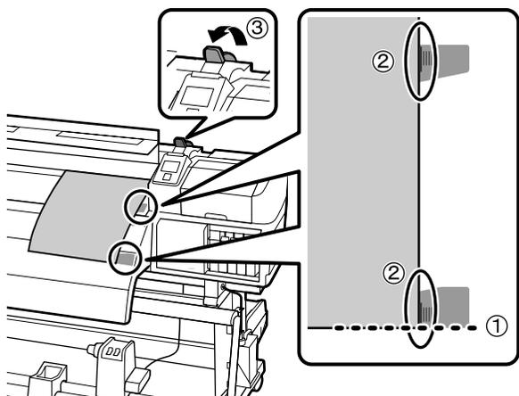
Zarovnajte spodnú časť nastavovacieho papiera so spodným koncom nižšieho štítka na after heateri. Zarovnajte pravý koniec s najdlhšími stupnicami na oboch štítkoch umiestnenými v strede štítkov. Po zarovnaní pozícií posuňte dolu páčku na vkladanie papiera.
