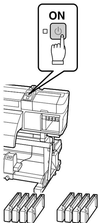
Zapnite tlačiareň a nakonfigurujte úvodné nastavenia, ako jazyk a dátum. Potom sa držte pokynov na obrazovke ovládacieho panelu pre vykonanie prvého naplnenia atramentom. Pri prvom naplnení atramentom najprv umyte hlavu (naplňte a vypustíte čistiacu tekutinu) a potom naplňte atrament. Po naplnení čistiacou tekutinou vyberte čistiacu kazetu, vypustíte čistiacu tekutinu a potom vložte atramentovú kazetu.
