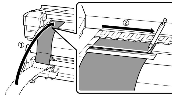
**[4]** Vytiahnite nastavovací papier, potiahnite ho na pravý koniec rolky, vložte ho do tlačiarne a zasuňte ho celý dovnútra.
