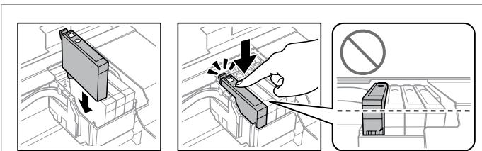
Włóż kasetę tak, aby rozległo się kliknięcie. Upewnij się, że wszystkie kasety są ustawione w jednej linii.
