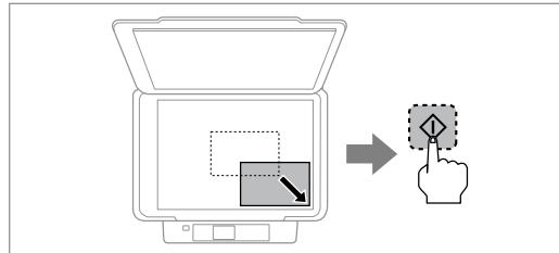
Namestite izvirnik in začnite s skeniranjem.
