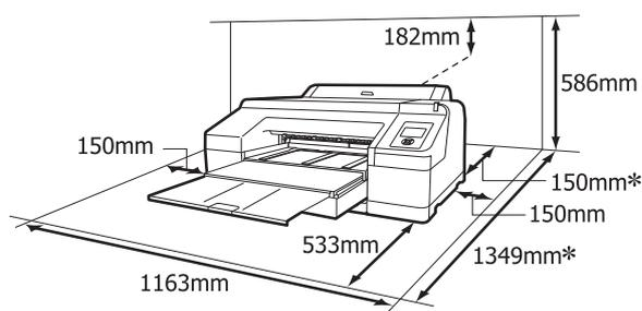
\* Данное пространство необходимо обеспечить сзади принтера при печати на плотной бумаге, а также при подаче бумаги из кассетного лотка при установленном устройстве SpectroProofer.
