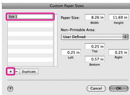
**3** Для параметра **Paper Size** установите значения настроек **Width** и **Height**, затем установите значения размеров полей и затем нажмите **OK**.
