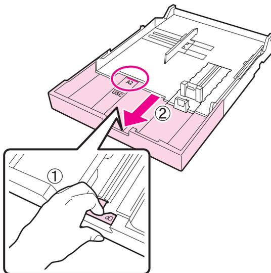
Для того чтобы увеличить объем кассетного лотка, надавите на рычаг, как показано на иллюстрации выше. В момент, когда рычаг отпускается, защелками фиксируется новый размер лотка.
