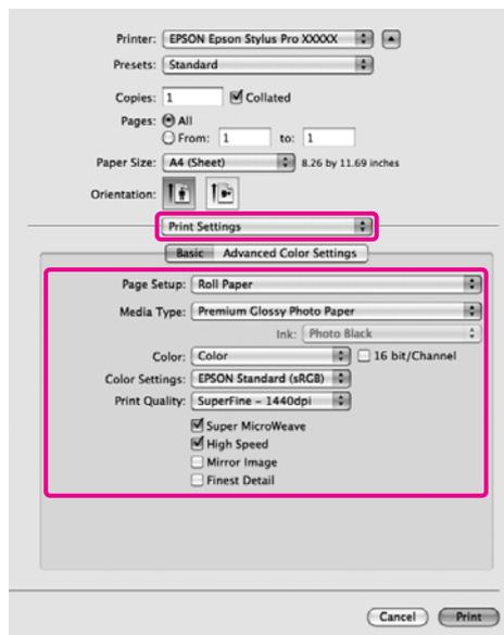
Задайте значения для параметров **Media Type**, **Color** и **Print Quality** в соответствии с методом подачи бумаги, загруженной в принтер (для форматных листов). Обычно возможно производить корректную печать, просто задав нужные настройки на экране **Print Settings (Настройки печати)**.
