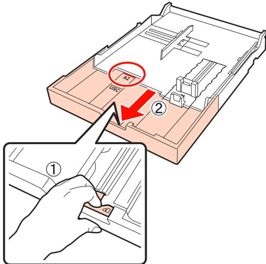
Tire de la palanca de la cassette del papel cuando la despliegue. Cuando suelte la palanca, la cassette se quedará fija.
