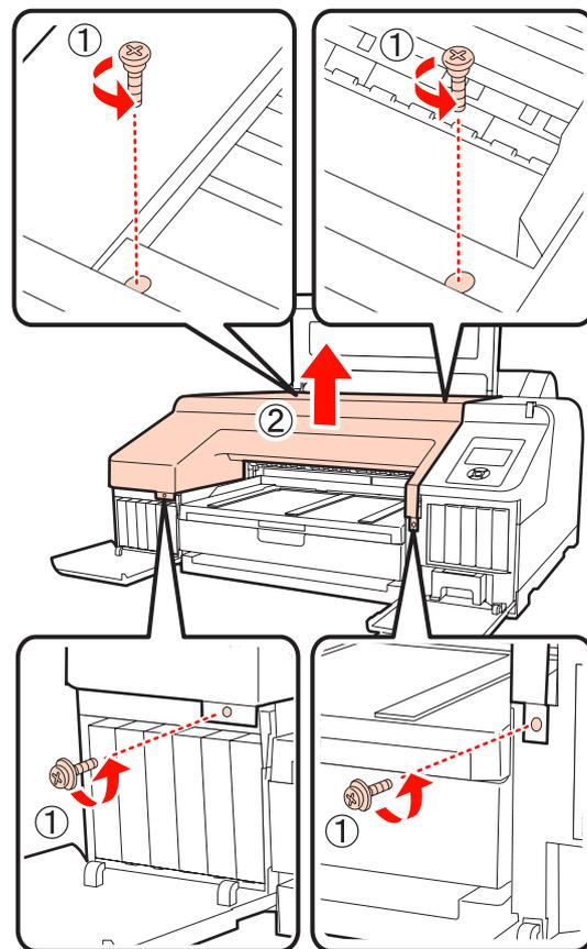
**5** Abra la cubierta del cortador.
