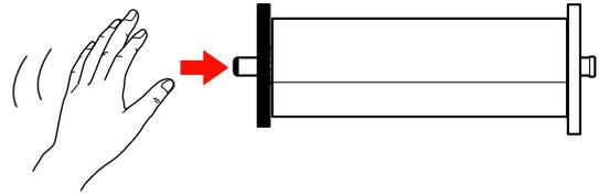
Si en el eje solamente queda la bobina del papel, sujete la bobina y empuje el eje para sacar el tope móvil.
