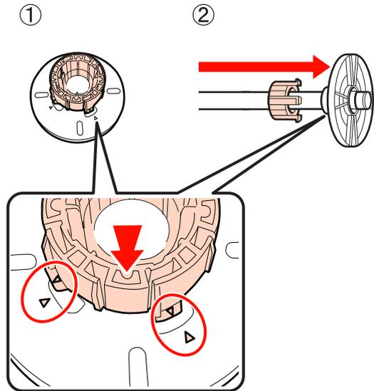
**Extracción e instalación del espaciador**
