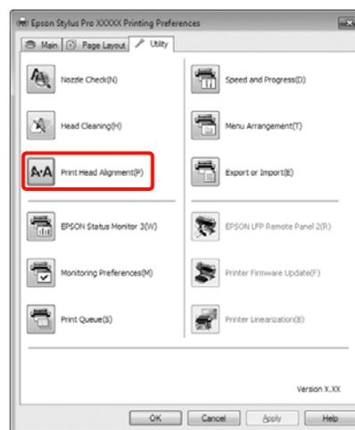
El sensor lee el patrón de ajuste durante la impresión, y registra el valor de ajuste óptimo en la impresora.
