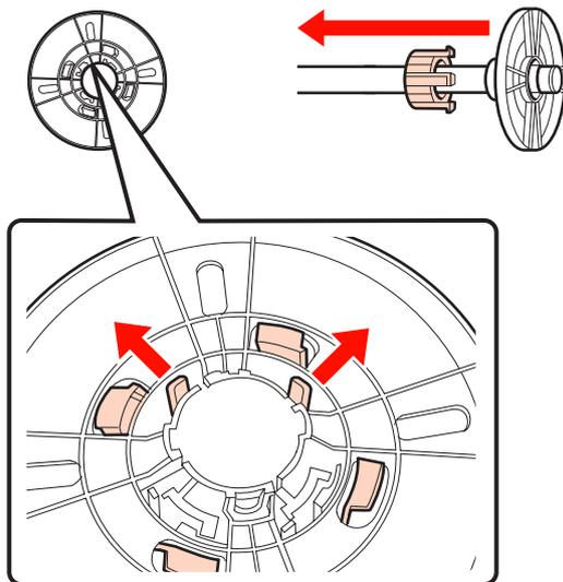
**Extracción del tope (para bobinas de papel de 3 pulgadas)**
