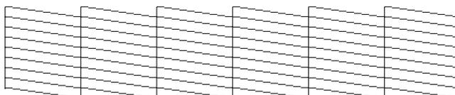
Si falta algún segmento en las líneas impresas, como se muestra a continuación, el cabezal de impresión podría estar obstruido o desalineado.
