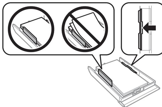
Deslice las guías laterales hasta que toquen los bordes de los sobres.
