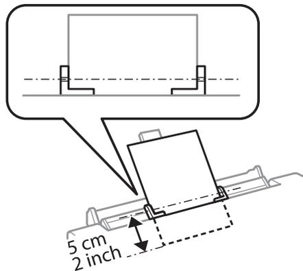
En el centro de la ranura posterior de alimentación de papel, cargue el sobre por el borde corto y con la solapa boca abajo. Después, ajuste la guía lateral.
