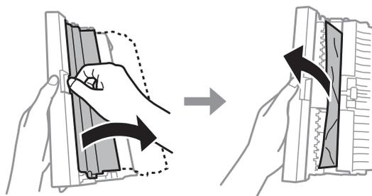
**4** Vuelva a colocar la cubierta posterior.
