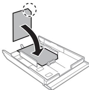
Para cargar sobres, use la cassette 2. Cargue los sobres con el borde corto por delante y con la solapa boca arriba y a la izquierda. Después, compruebe que los sobres no sobresalgan de la cassette.
